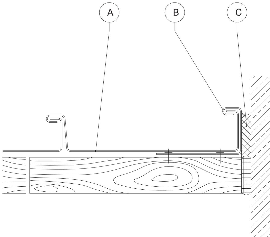
A FASSADENBEKLEIDUNG 0,8 mm
