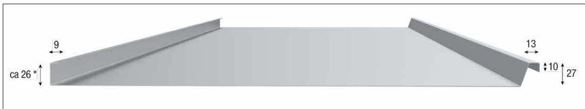
Obrázek 6.1.2 Krytinový pás s rozměry drážek
