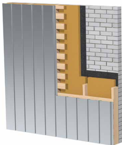
Svisle kladený panelový systém
