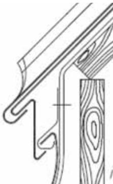
Als Endung der Falze an der Traufe stehen mehrere Ausführungen zur Verfügung:
